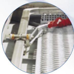
Entre el arnés conforme a la norma EN 361 y el carro, se debe utilizar una cuerda o cinta equipada con un absorbedor de energía según norma EN 355.
